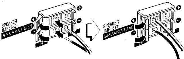
Le cordon d'enceinte à rayure blanche doit être raccordé à la borne **+** et le cordon noir à la borne **-**.
